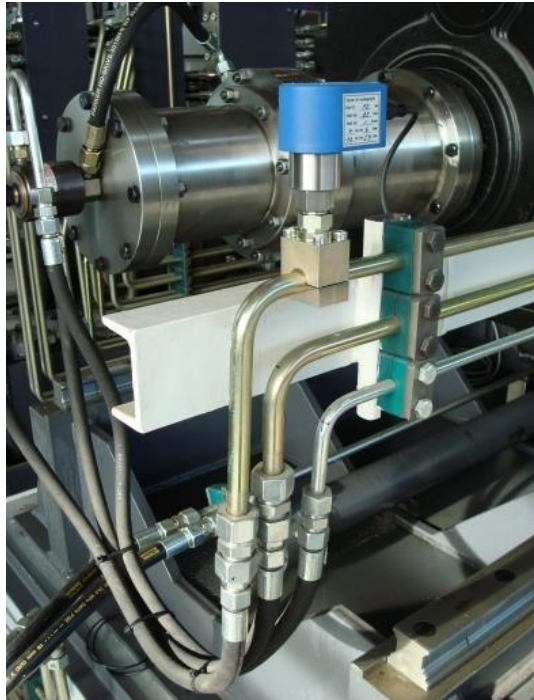
Abbildung 3: Leckagesensor fluid-Check® mit serv-Clip® -2 zur Erkennung von Dichtungsschäden am Spreitzylinder einer Haspelmaschine
