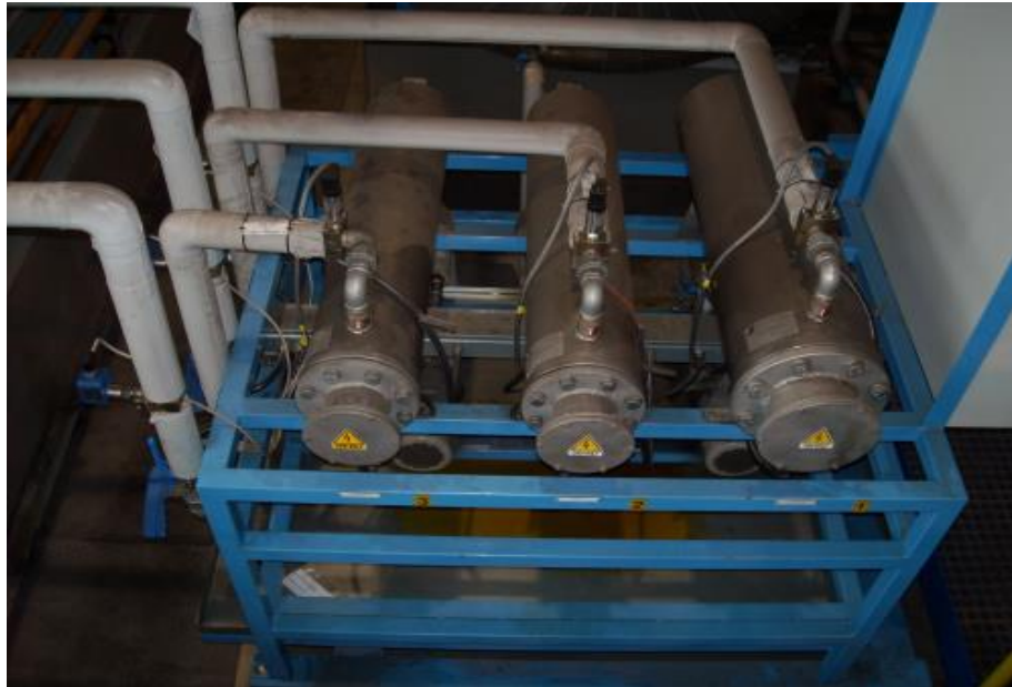
Abbildung 1: Druckmessung an einer Durchlaufheizlinie für Einfettöle mit serv-Clip® -1 und Drucksensor DS-1-A-400-1/4“ fluid-Check®
