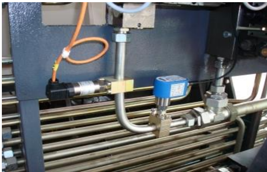
Abbildung 2: Rohrmessanschluss serv-Clip® -1 mit Drucksensor - Gewindeanschluss G 1/4“
